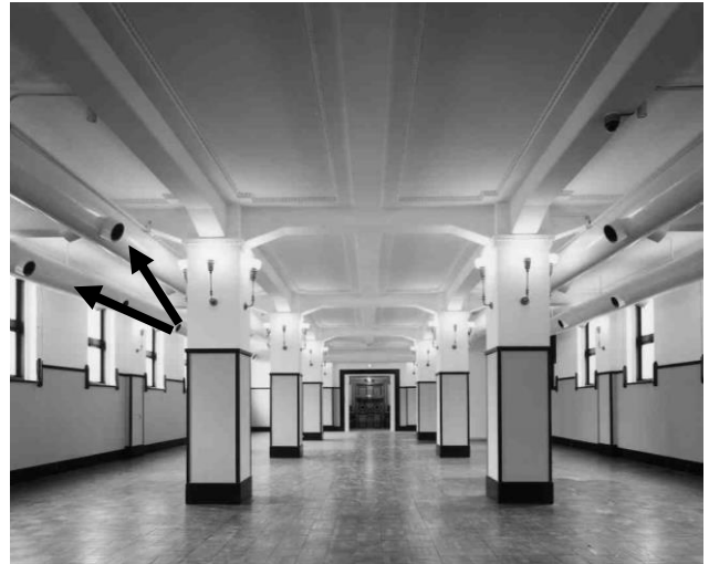
改修後（空調設備：室内ダクト吹き出し方式）
