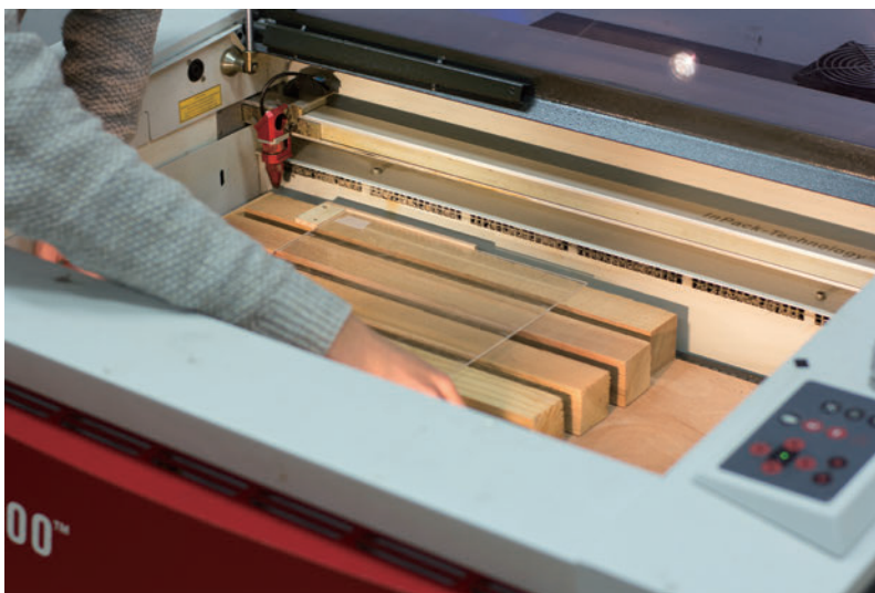
[fig.49] レーザー加工機のテーブルに合わせて作られた治具の上に角材をセットしていく
