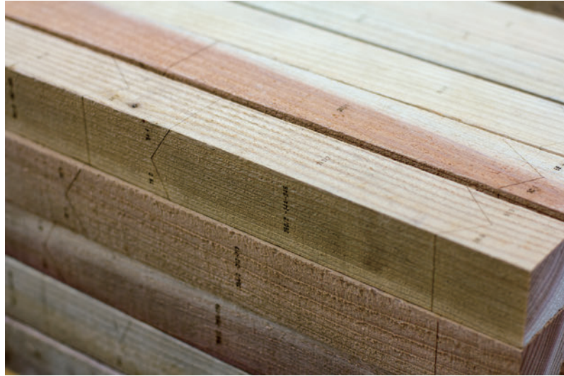
[fig.51] 2つの側面にケガキ線を入れる。
