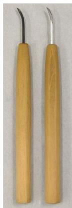
図 71 首を横方向に曲げた印刀
