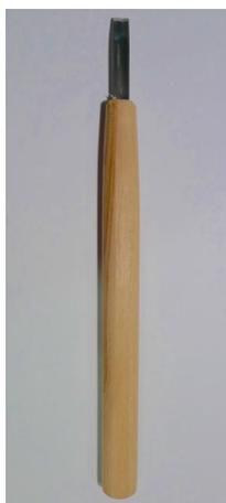
図 75 鋼の方向に曲げた外丸刀
