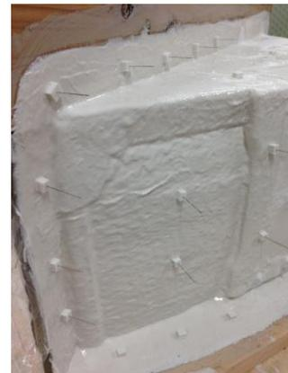
「ダボ」は余ったシリコンなどをカップの底などに溜め、完全に硬化させたものを7・8mm四方の角切りにしてつくる。5層目のシリコンを塗り完全に硬化する前に、約5cm~10cm間隔で配置する。傾斜している面や垂直な面などには「ダボ」を置いても重力に従い移動し落ちてしまう。そのような時は、針でシリコンの「ダボ」を串刺ししたものを土台に刺すことで、重力で動いたり落ちたりすることなく、固定し意図する位置に「ダボ」を付けることができる。
