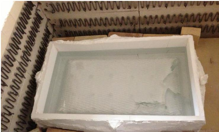
再度徐冷プログラムを延長し焼成を行ったが再び同じようなひびが見られた。ひびの形状を見ると、右側から左側に向かってヒビが進行している。よく見ると、葛籠の網目の形に添ってひびが進行している、更に、同じ型を2度焼成している
