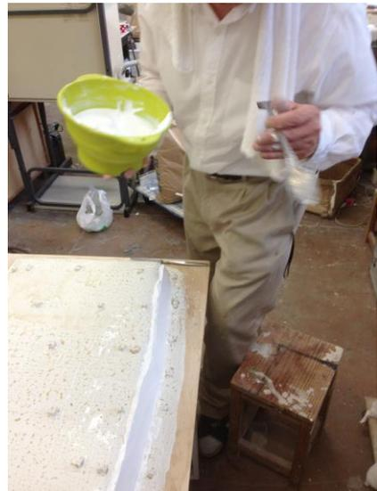
と同じ役割を果たし、型を強くすると同時に、ひびが入ったりしたときに割れて崩壊するのを防ぐ役割がある。円盤状に丸めたスタッフを、石膏を溶いたボールの中に入れ、まんべんなく石膏を吸わせてから湿布を貼る様に全体に塗布していく。スタッフでまんべんなく蔽えたら、更にもう1層の石膏をかけ、表面を整える。盛り上げ法とスタッフの活用によって薄く、且つ軽く石膏型を作ることができる。あまりに薄く軽い型は、どうしても衝撃によっては割れてしまう可能性が強いので、木材を骨組みとして補強をする必要がある。木材による型の補強づくりにおいても、どこにどのような補強を入れるべきかの判断は、経験的な構造の見極めが必要となる。本制作においては、型の形状の各辺にあたる部分と広い面の中心に角材をあてがい焼石膏で固め固定した。
