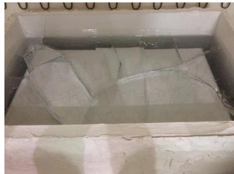
初めて使う鑄金工房の窯であったが、プログラムコントローラーの不具合により、徐冷時に温度が急降下するトラブルがあり、作品が2つとも割れてしまった。縦横に横切る割れの具合から見ても、徐冷ミスによる割れであることがわかる。
