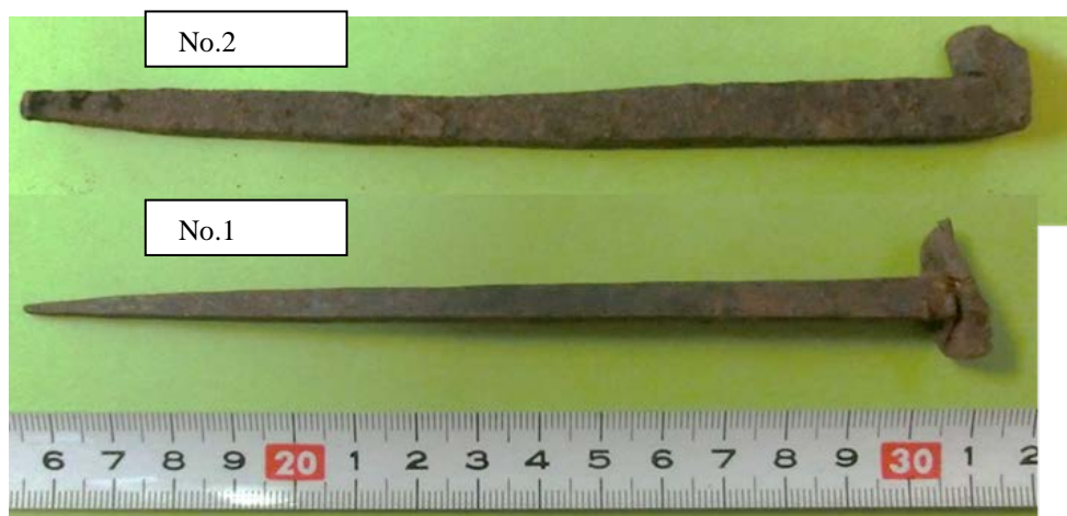
No.1 奈良西大寺三門の釘及び No.2 垂沼美神社の釘の外観
