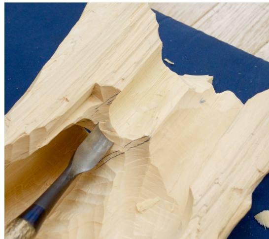
図 106 丸鑿による像底の彫り崩し
