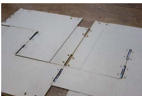
3. 数の多いの谷折の兆番をまとめて接合することで、全体の精度を高める
