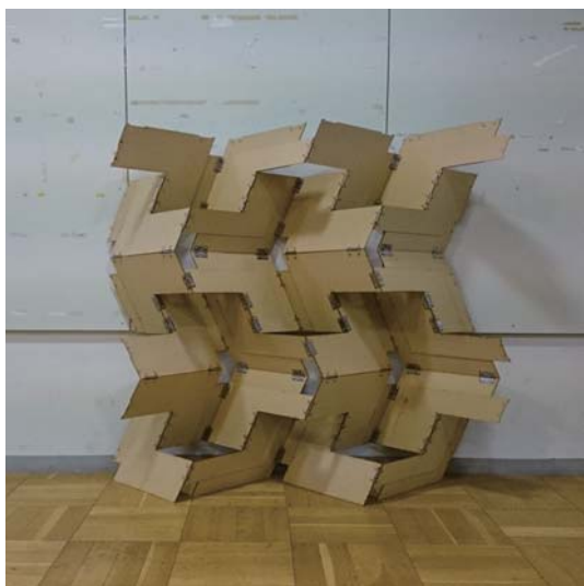
3. 各面が 90^\circ をなすよう折畳んだ状態
