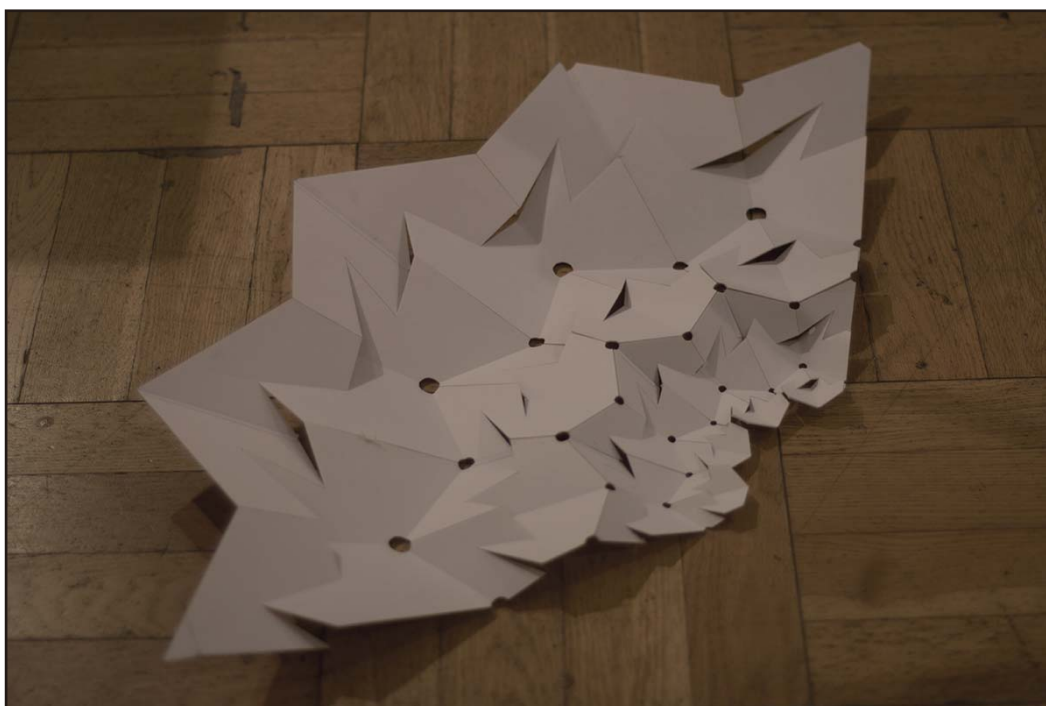
図45 扇型ミウラ折球面シザーズ機構の可動検証用模型
