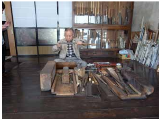
図 144 中屋のこぎり店 関澤可千氏による鋸目立て作業（2012 年撮影 長野県松本市）
