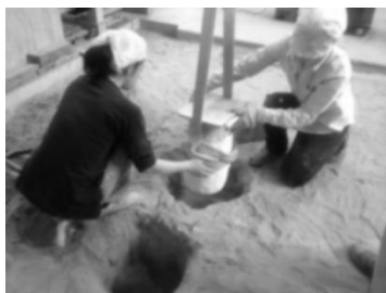
図 50 土間に穴を掘り鑄型を埋める様子
