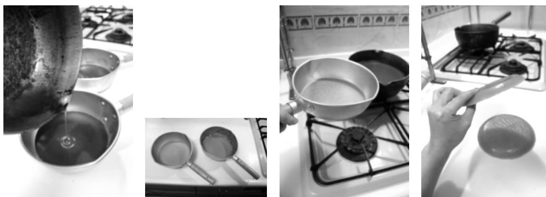
図 13 鍋で溶かしたワックスを冷やし固め、鍋底をあぶって取り出す
