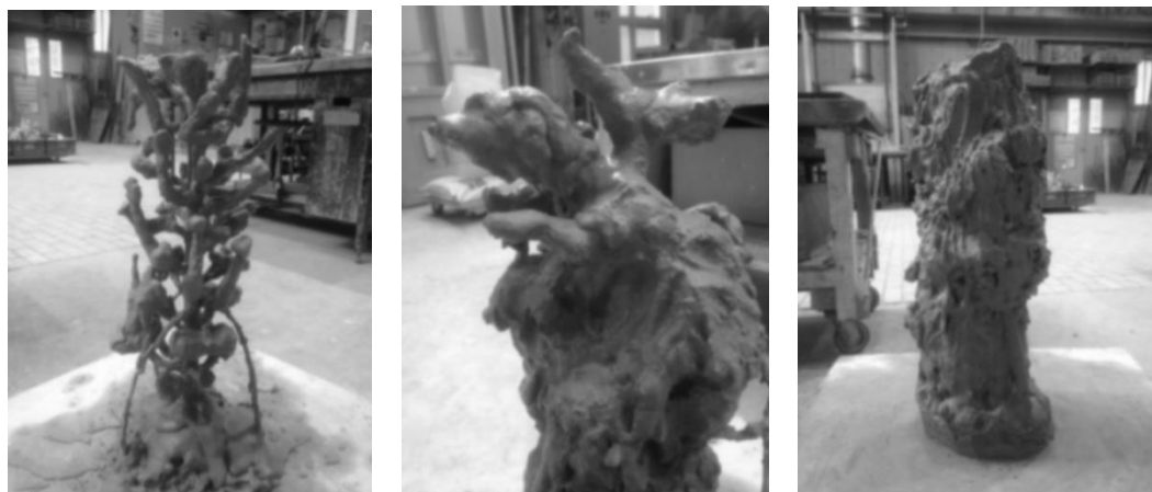
図 20 埋没材を湯道のついたワックスに吹きかけて覆ってゆく。石膏が硬化するので、重ねて覆い隠してゆく。指先で跡をつけ、次につく埋没材との間が馴染むようにしている。
