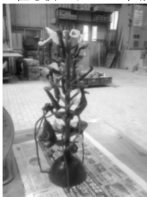
図 16 ワックス原型に湯道（青いワックス）を付けた様子
