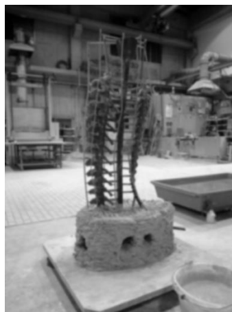
図 49-2 全貌、高さ 130 センチはあるワックス原型
