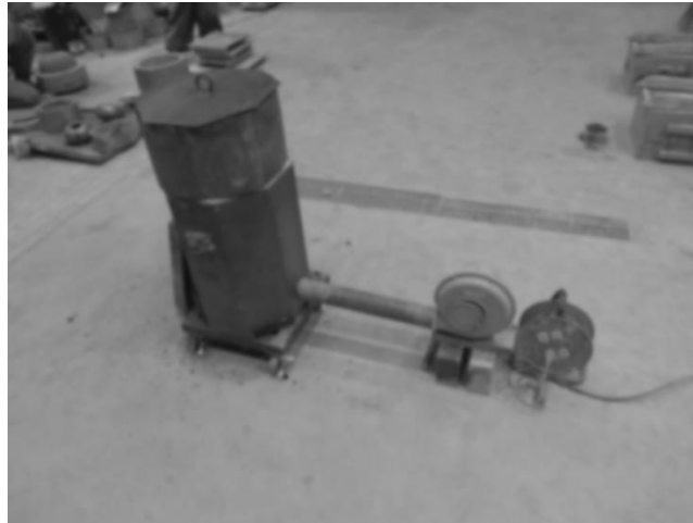
図 33 自作の溶解炉
