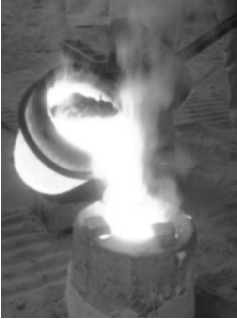
図 23 左：鑄込みの様子 ワックスは消失し、空洞になったところにブロンズが流れてゆく 右：鑄込み直後の様子
