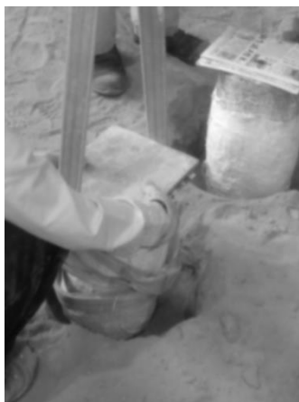
図 18 土間に穴を掘って鑄型材を固定している様子
