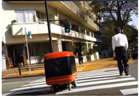
播磨坂の歩道は幅も 4m くらいあり、極力端を走行し人や自転車とすれ違う際にはロボット側が一旦停止する
