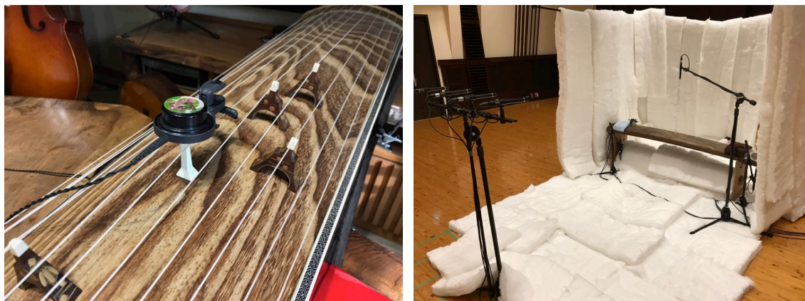
写真 3.2: 写真左は振動スピーカを楽器に取り付けた様子。専用の駒（柱）を使って箏に取り付けている。また、この振動スピーカを箏で使用する場合、箏の中心に設置することを推奨している。写真右はスタジオ A 内に設置された箏とポリエステル断熱材を使用した仕切りの様子。床面にもポリエステル断熱材を敷きつめた。
