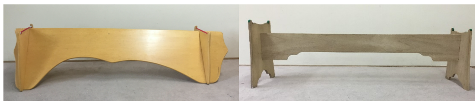
写真 1.1: 写真左はアカンサス型、右は H 型 -1 の立奏台。アカンサス型は反射板に傾斜をもたせてあるが、H 型 -1 は床面に対して垂直に取り付けられている。
