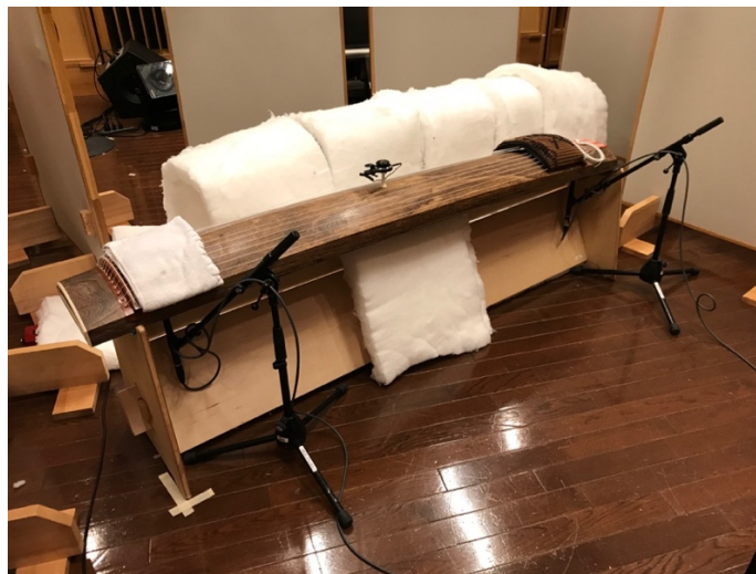
写真 3.4：反射板中央に開口部を設けることを想定して幅 42 cm のポリエステル断熱材を置いた様子。
