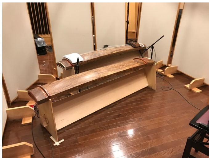
写真 3.5：測定の様子。後方の箏に振動スピーカを取り付け、前方に 2 枚板 - 1 型の立奏台の 2 枚の反射板で構成されているうちの上部の 15 cm の横板の着脱した場合にどのような周波数特性があるのかを調査した。
