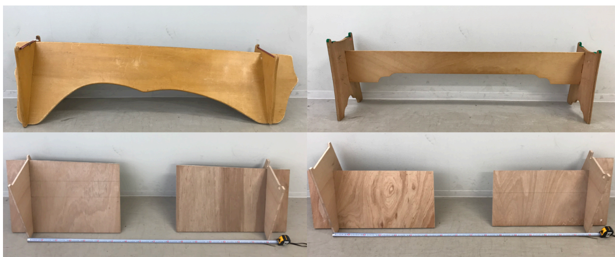
写真 5.2 : 実験で使った立奏台を示す。上段の左から東京藝術大学で使われているアカンサス型、H 型。下段の左から今回提案した反射板 J ( 20 - 0 ) と M ( 20 - 15 ) である。
