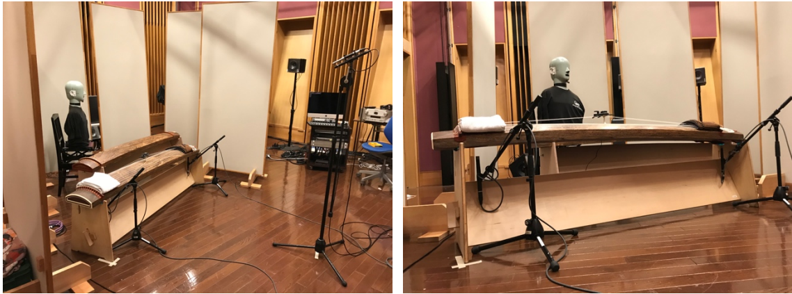
写真 3.3: スタジオ B で行なった事前調査の様子。箏 2 面を 34 cm の間隔に前後に並べ、前方の箏に振動スピーカを取り付けた。写真左はそれぞれの配置を示し、写真右は 2 枚板 - 1 型立奏台の 2 枚ある反射板のうち、上部の 15 cm の横板が取り除かれている様子。
