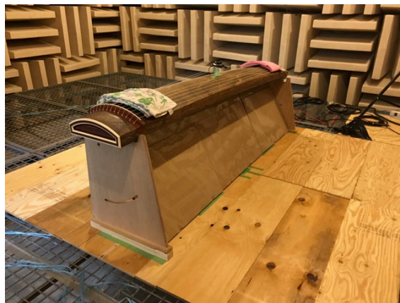
写真 4.2：無響室での測定の様子。左の写真では箏の下には一枚板状の反射板が設置されている。振動スピーカを再生したとき、箏の表面には張られている絃が振動してしまうため、布を絃に挟み込んで振動を抑えた。
