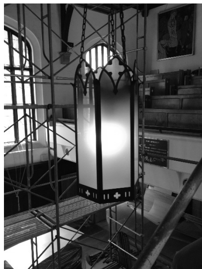
写真 3-2-28： 現場での照明実験 既存器具の光源を入れ替えて、現地で確認。
