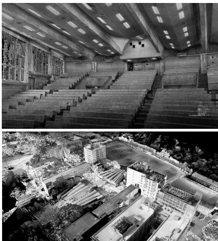
図3-3-40： 改修前の点群測量による記録保存
