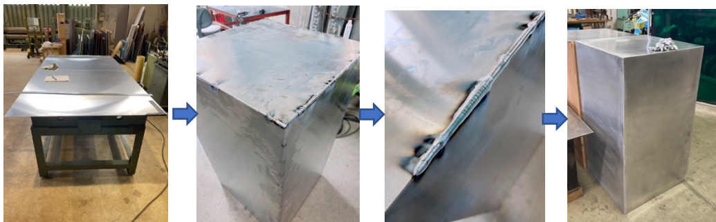
図 87 切り出し前の素材 → 素材の溶接 → 接合部 → やすりをかけて完成した状態
