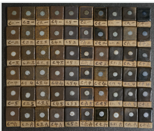
図 30 炭化還元焼成 焼成結果
