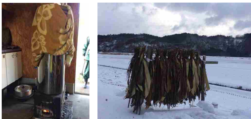
図 1-32 左:②楮蒸し、右:③皮剥ぎ(ざっくりと剥いだ黒皮の乾燥)
