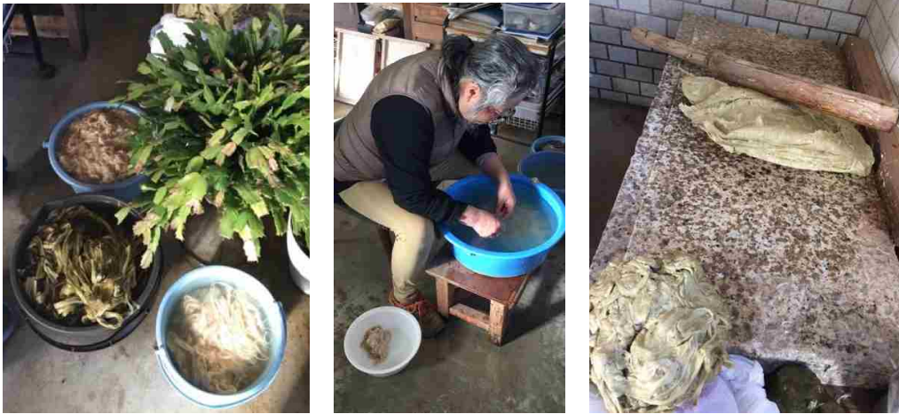
図 1-34 ⑤ 煮熟(煮熟前後の楮)、中:⑥ チリ取り(水に楮を浮かべながら探す)、右⑦ 叩解(石板と木槌)
