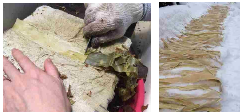
図 1-33 左:④手繰り(表皮の黒皮を剥ぎ白皮のみにする、右:雪晒し)
