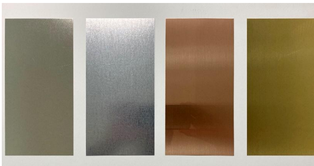
図 16 酸化する前の原型(左からブリキ、鉄、銅、真鍮)
