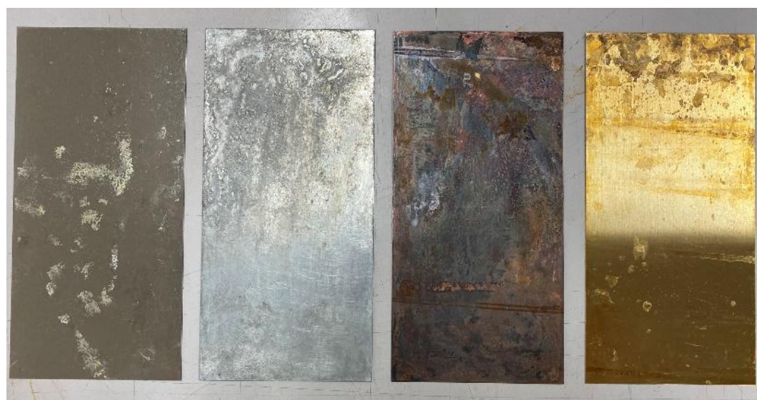
図 17 酸化後(左からブリキ、鉄、銅、真鍮)
