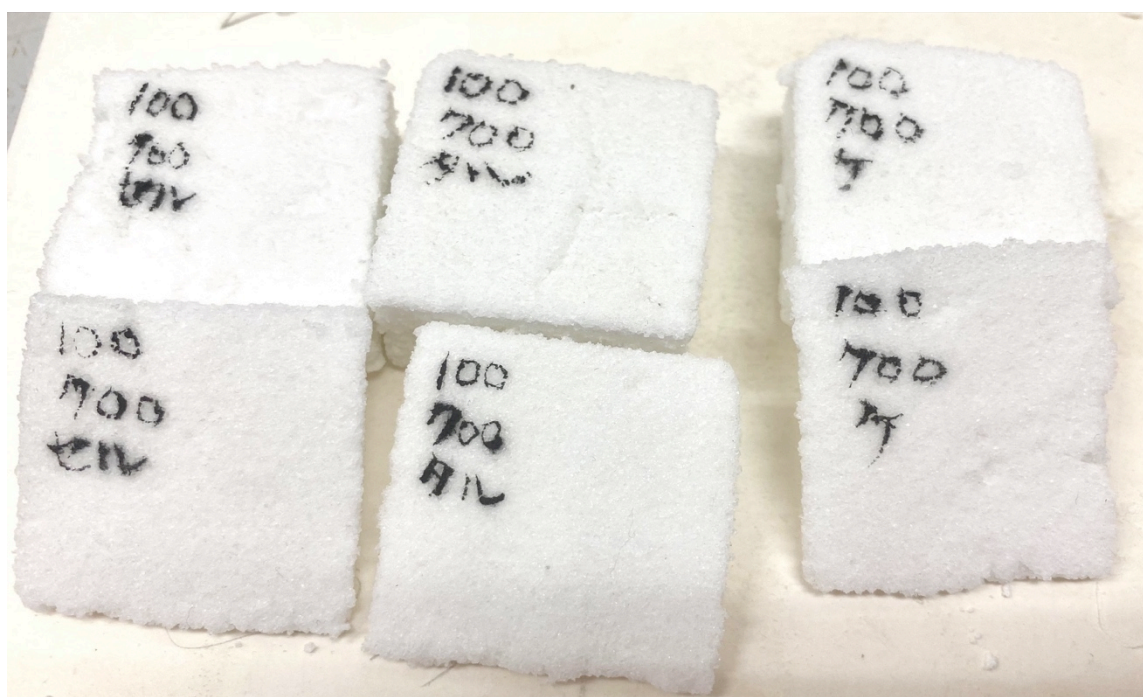
(図 3-9) 焼成前のテストピース①の配合
