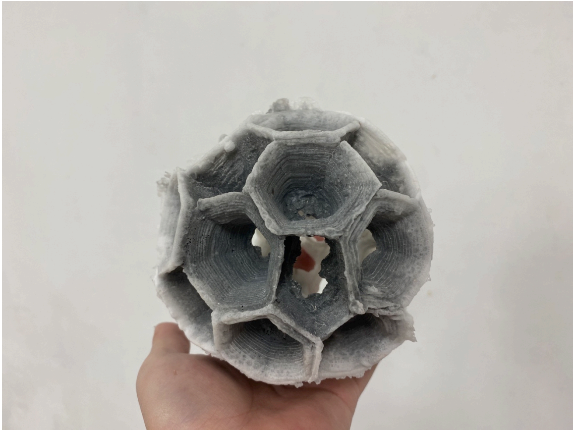
(図 3-25) ガラスペーストを出力できる 3D プリンターで制作した作品 (筆者撮影、2020 年)
