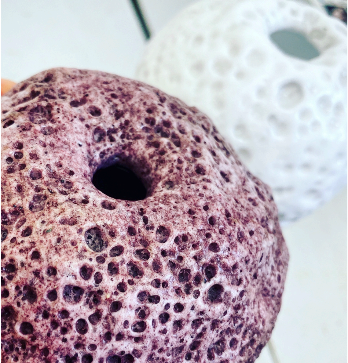
(図3-15) 吹きガラス技法でピックアップして溶着した、ガラスペースト (筆者撮影、2020年)
