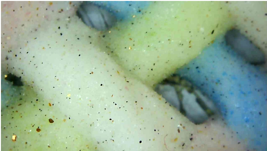
図 3-10 珪砂で埋没焼成した作品の表面 (筆者撮影、2020 年)
