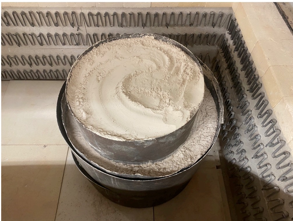
図1-10 耐火粉に埋没させた様子
