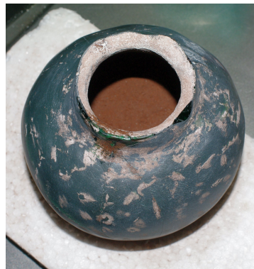
[図13] 左:実験製作身B 外型から割出した状態 右:実験製作身C 内部
