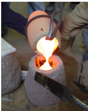
[図11] 実験製作身A 鑄造時の様子
