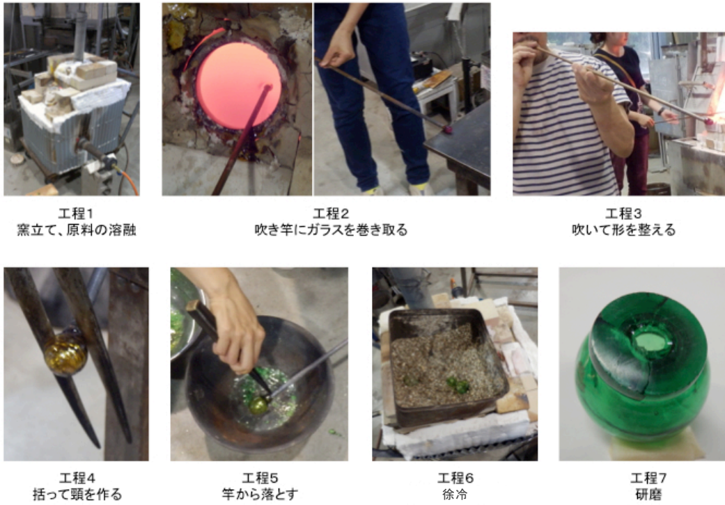
[図24] 宙吹き技法による実験製作
