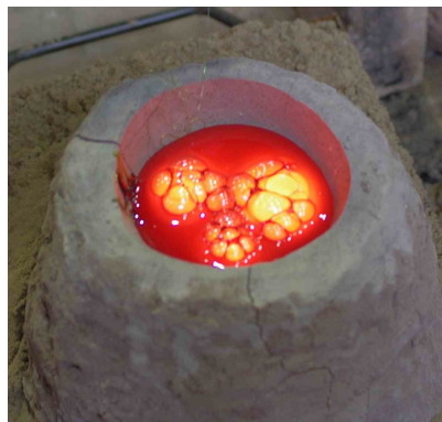
[図12] 実験製作身A 鑄造後に発生した気泡
