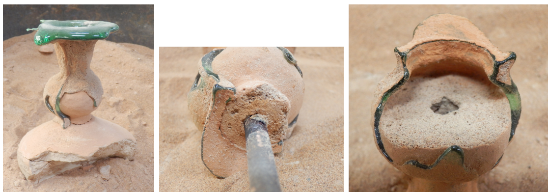
[図28] 大飛鳥小壺再現実験品ハ 左:外型から割り出した状態 中:口唇部 右:口唇部断面
