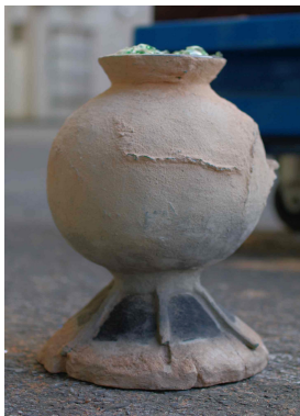
[図13] 左:実験製作身B 外型から割出した状態 右:実験製作身C 内部
