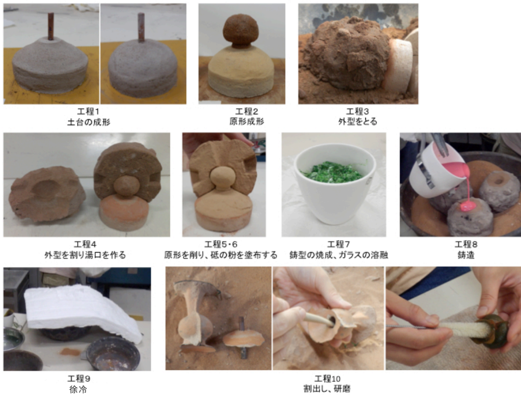
[図25] 鋳造技法による実験製作
