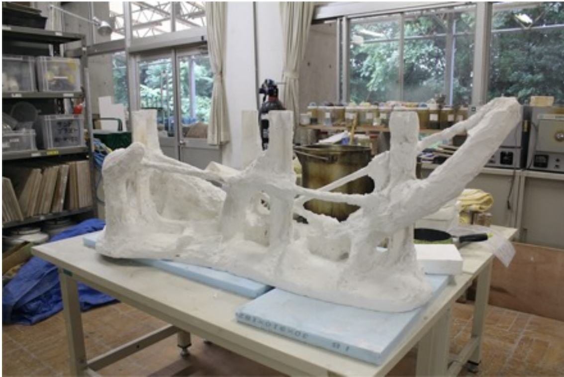
写真 12：5号炉用の型。スペースの都合で湯口と一体型に制作
