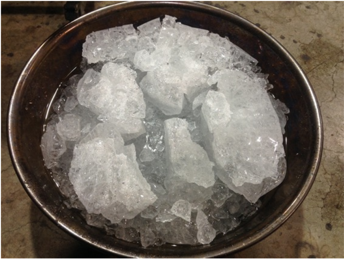
写真 20：溶解炉から溶けたガラスを取り出し、水に入れ急冷させ、割る
