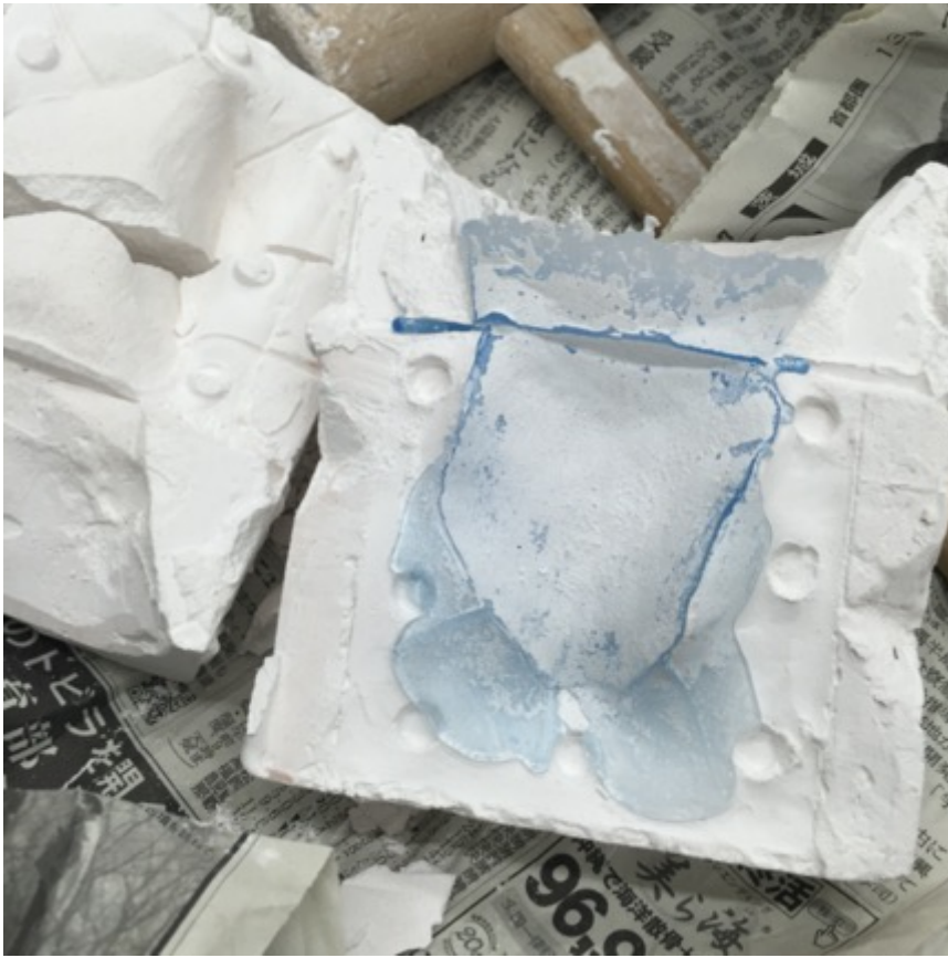
写真 34：ガラスの割り出し作業
