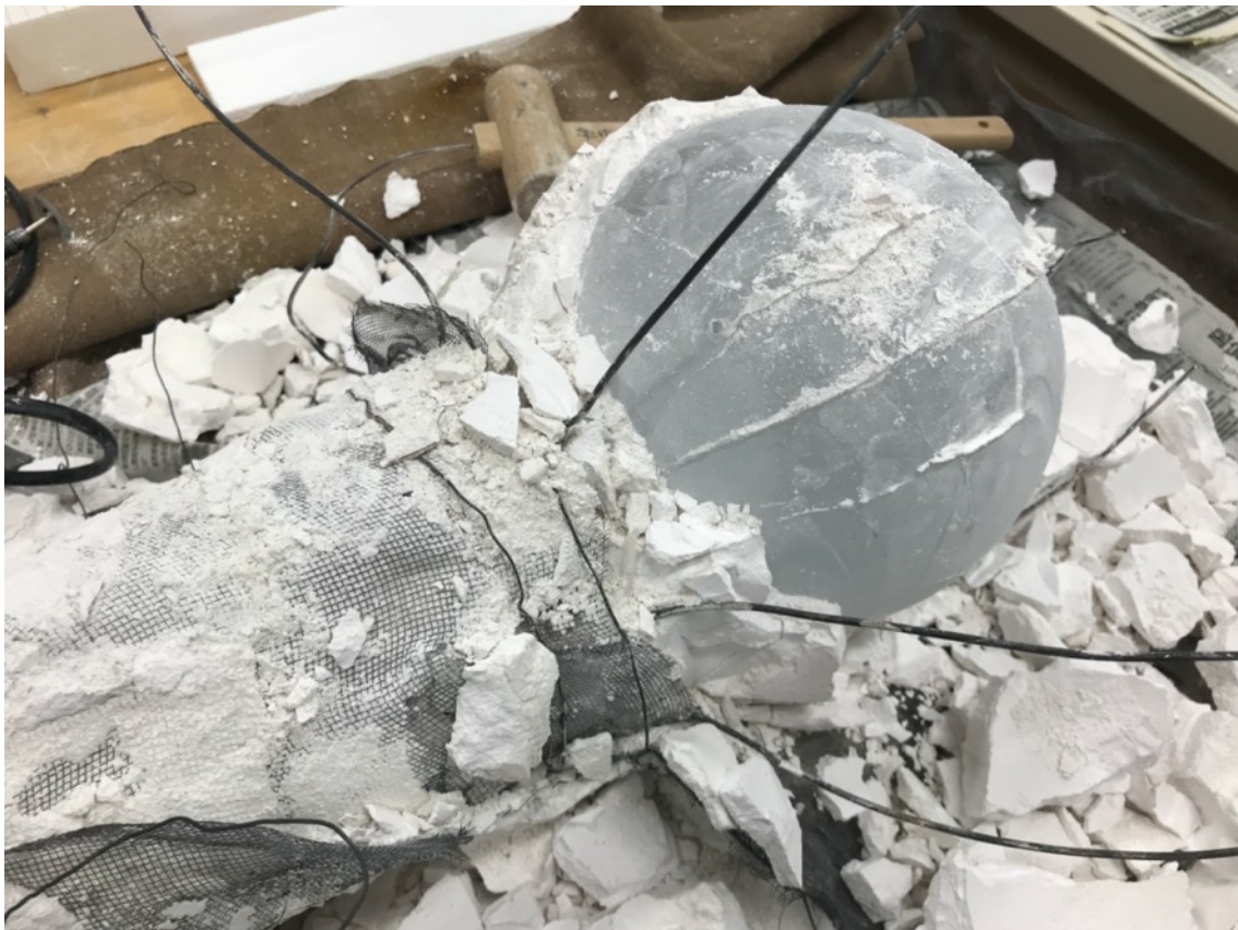
写真58：割り出しの様子
