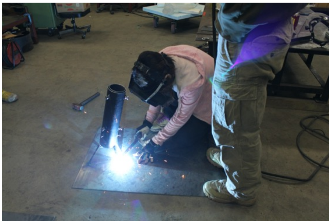
写真 21：角のスタンドを鉄で作る。溶接の様子
