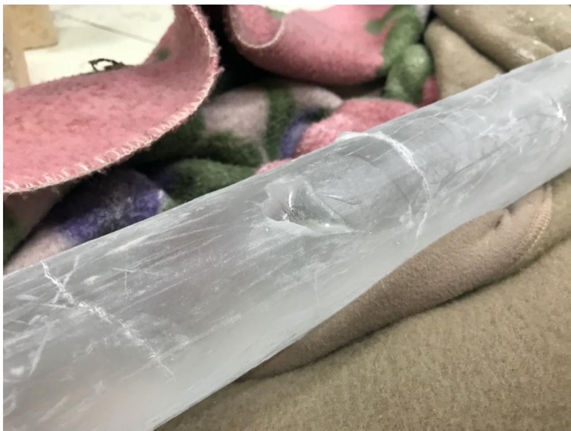
写真 57：1 度目の割り出し。ガラスに凹みがある
