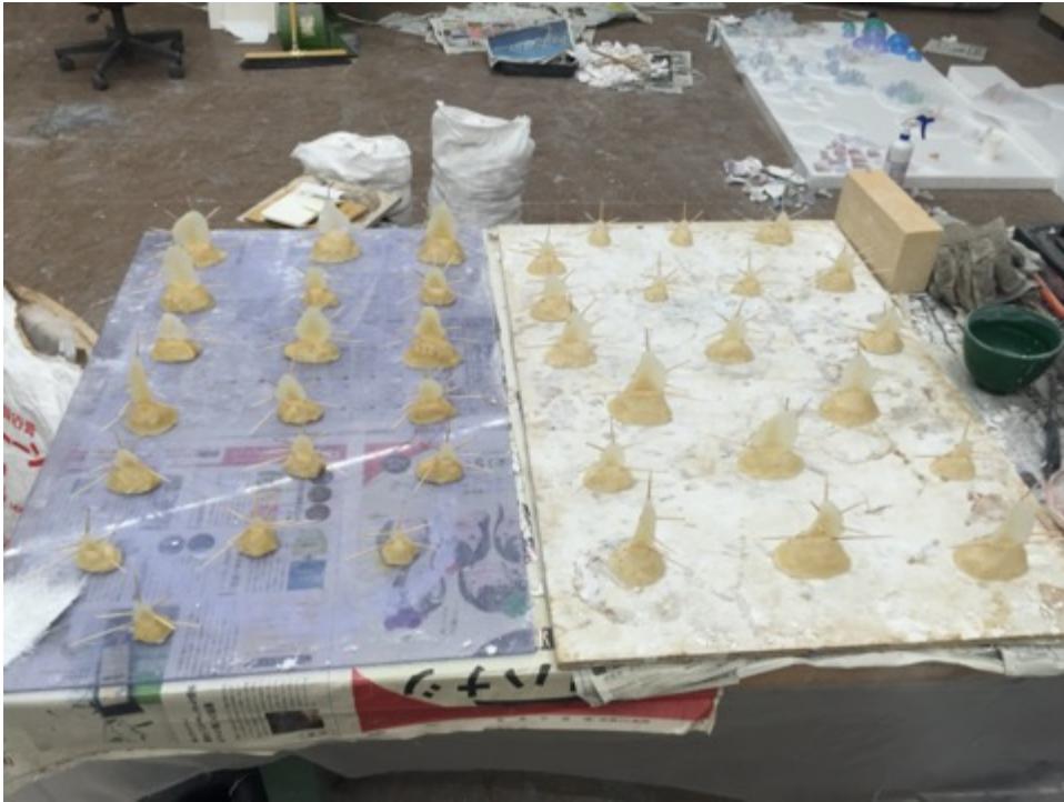
写真 32：ワックス原型に空気穴になる部分を熔着させている風景
