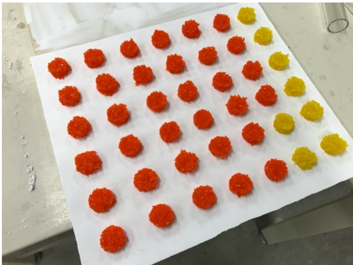
写真 26：鱗の制作。石膏板の上に離型シートをしき、ガラスのカレットを丸い形に並べる。
