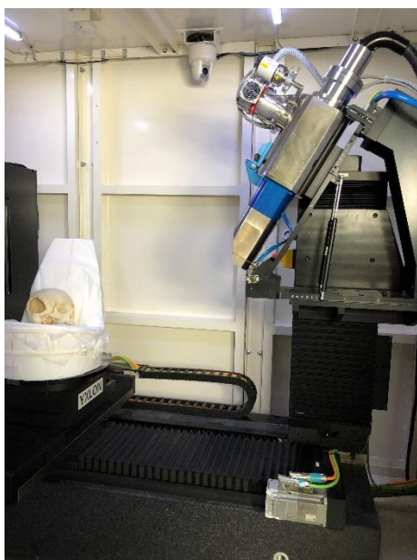
図102 YXLON CT Precisionによる頭骨寸法の3次元データ測定 (上：頭骨セット状態、上右：機器の操作状況)
