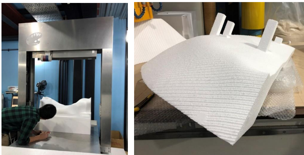
図 109 3D データから発泡スチロールブロックを切削用ドリルで部材を削り出す
