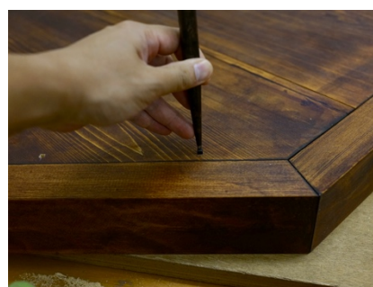
図20 和釘による天板の固定
