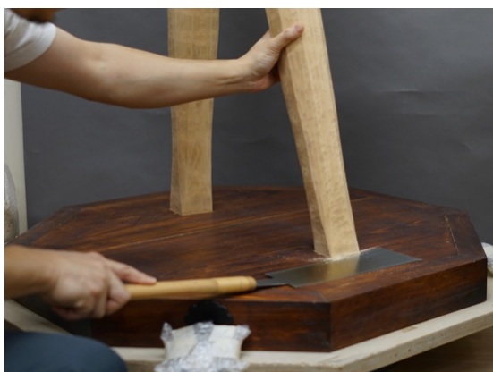
図 46 八角框座天板の水準で両脚を切り離す
