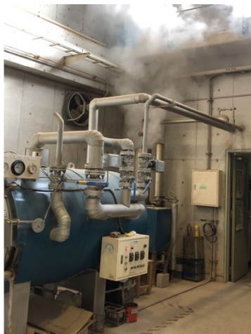
図 115 (左)(中)3 時間の間隔で乾燥、八層目まで付ける 図 116 (右)オートクレーブでの脱蠟
