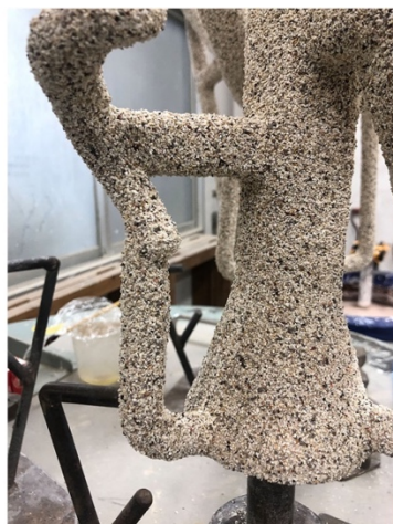
図 115 (左)(中)3 時間の間隔で乾燥、八層目まで付ける 図 116 (右)オートクレーブでの脱蠟
