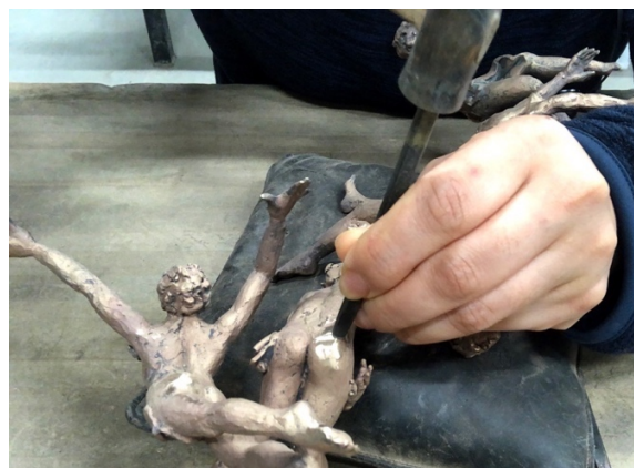
図 142 鑿による仕上げの様子
