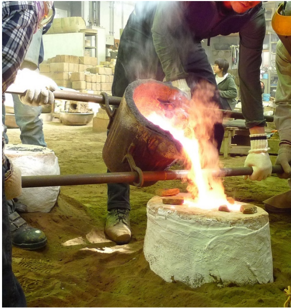
図 36 石膏埋没鑄造法の吹き - 落とし吹き
