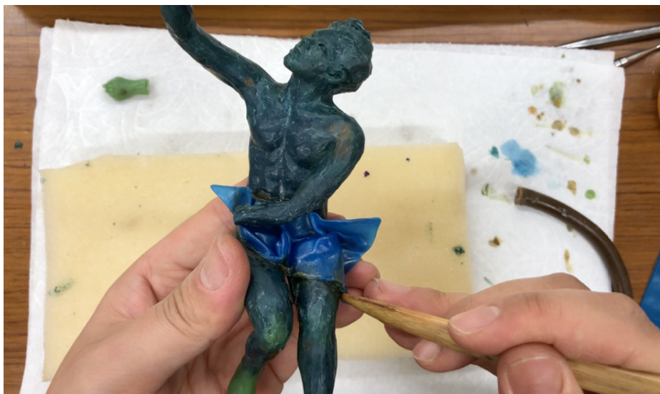
図 25 竹ベラで蠟原型を修正
