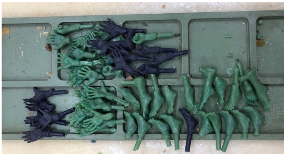
図 45 インジェクションワックスで得た手と足のワックス原型
