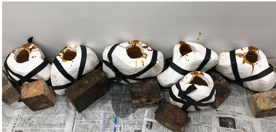
図 44 シリコン型にバックアップワックスまで流し込んだ状態
