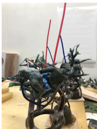
図 74 ガス抜き
