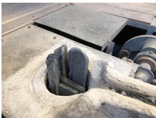
図 120 高周波炉で溶解開始
