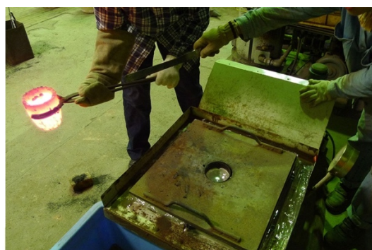
図 96 吹き時、坩堝と鑄型の距離を置く
