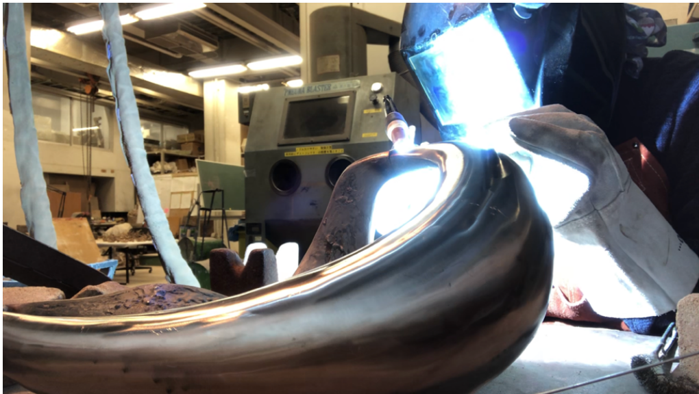
図 138 ステンレススチール溶接の様子
