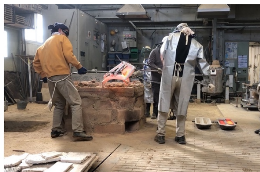
図 123 フォークで鑄型を移動
