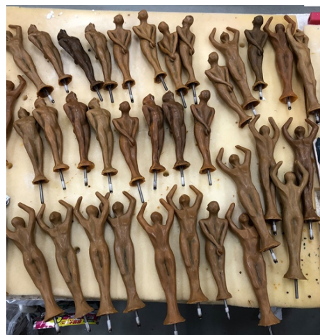
図 63 ワックス原型にねじを接合
