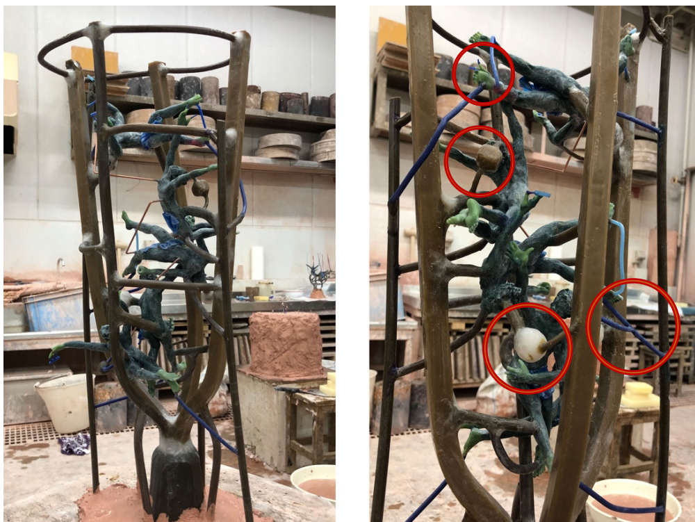
図 66 石膏埋没鑄造法の湯口系
