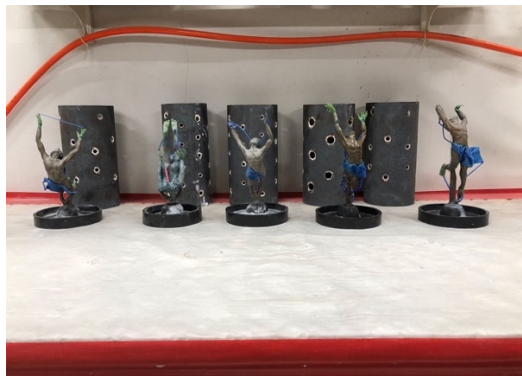
図 102 精密鑄造法の湯口系
