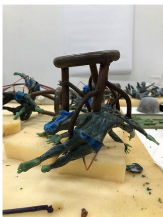
図 73 減圧鑄造法の湯口系
