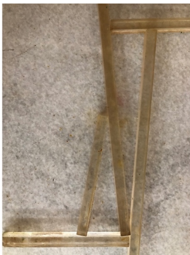
図 51 バックアップワックスを利用、作品の大まかな形を作る
