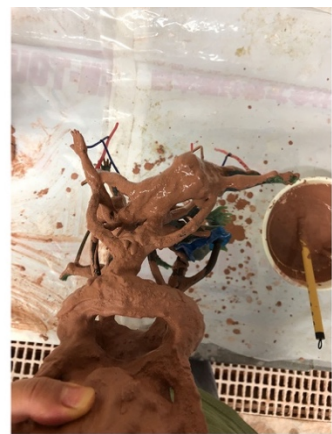
図 78 (中) (右) 肌用埋没材を上下にひっくり返して塗る
