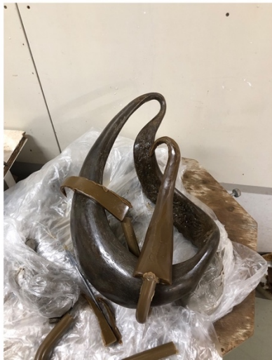
図 52 バックアップワックスの上に肌用ワックスを塗って形を整える
