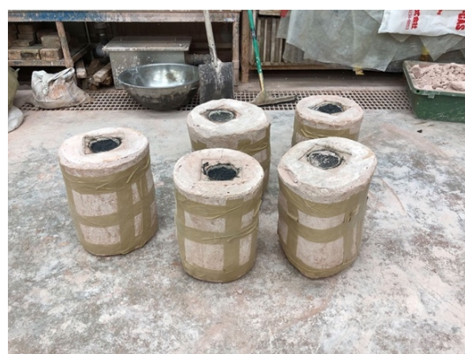
図 100 吹き完了後の鋳型
