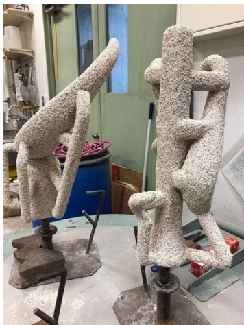
図 115 (左)(中)3 時間の間隔で乾燥、八層目まで付ける 図 116 (右)オートクレーブでの脱蠟
