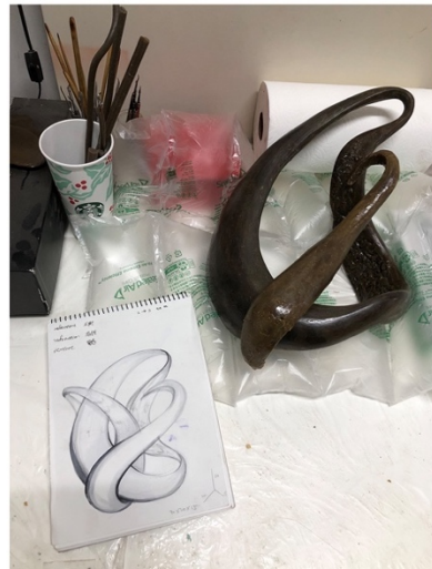
図 52 バックアップワックスの上に肌用ワックスを塗って形を整える
