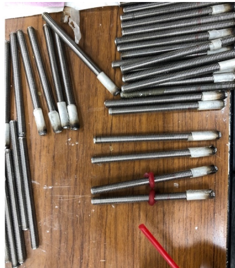
図 62 コールドジョイント用ねじの準備
