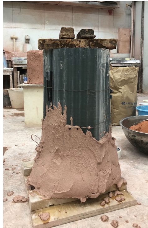
図 67 石膏埋没鑄造法 - 埋没
