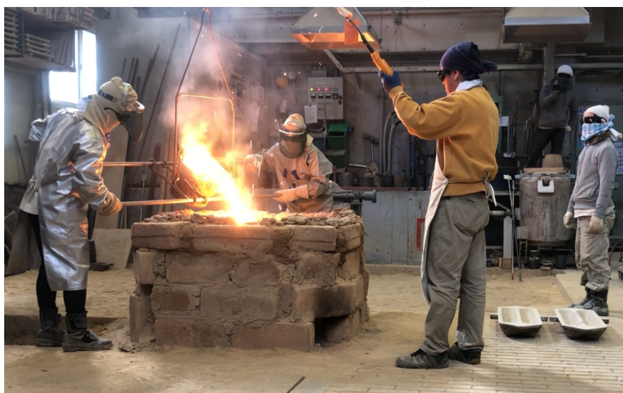
図 38 セラミックシェル型鑄造法の吹き
