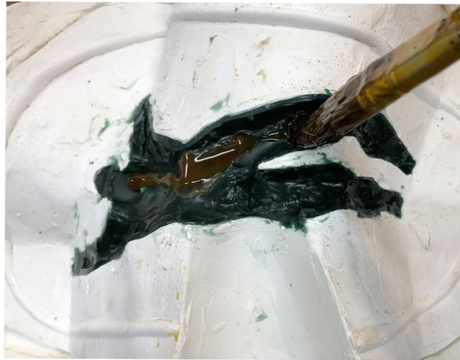
図 43 肌用ワックスをシリコン型に塗る
