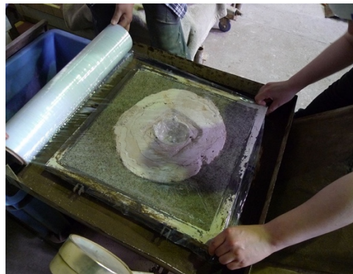
図 92 ラップを横縦二重に完全に密着させる
