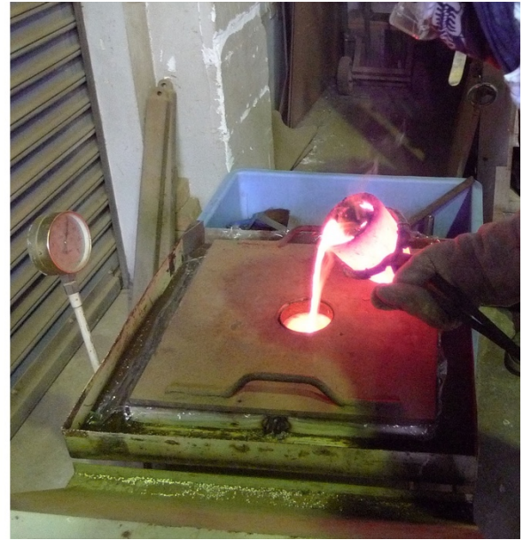
図 37 減圧鑄造法の吹き
