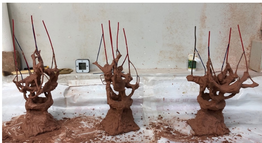
図 79 三層目まで塗った肌用埋没材
