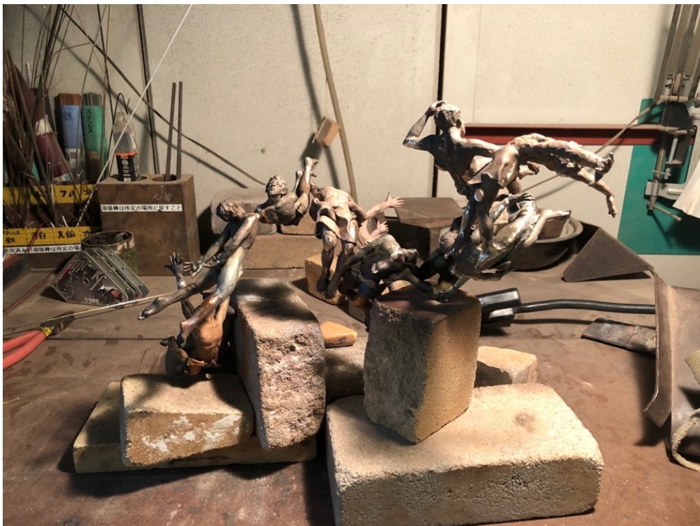
図 139 ブロンズ溶接の様子
