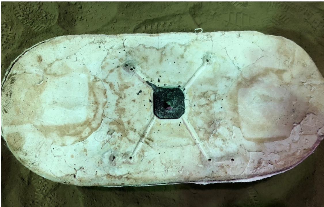
図 134 吹き完了後の鋳型
