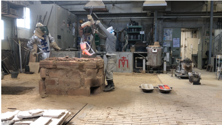
図 39 鋳型冷却のため、フォーク等で鋳型を移動 高温状態の鋳物がセラミックシェル型にそのまま映し出された様子
