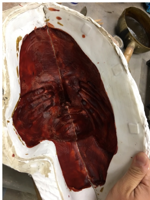
図 24 蠟の厚みがついた雌型の内部
