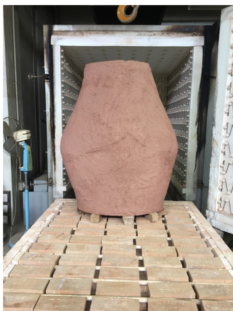
図 60 電気炉で焼成前の鑄型
