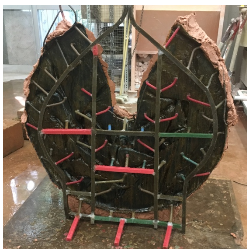
図 59 作品の裏側に張り巡らせた、注湯のための堰と湯道
