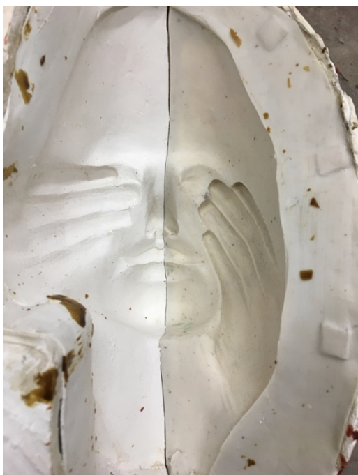
図 23 雌型の中に反転して現れる原形
