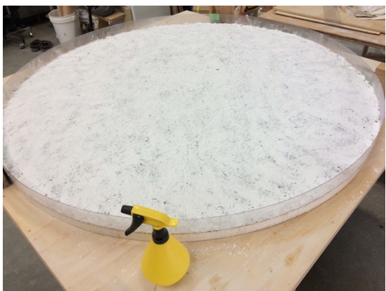
図 56 石膏の粉をかけ霧吹きで水を噴霧する
