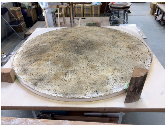
図 54 硬質石膏原型の表面を荒らす
