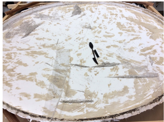
図 53 雌型の内側を磨く
