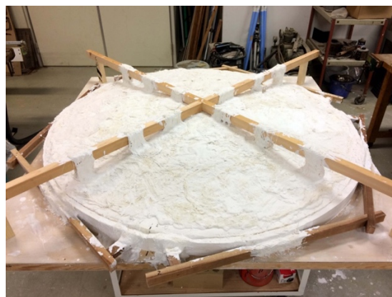
図 59 つなぎ合わせて型を補強
