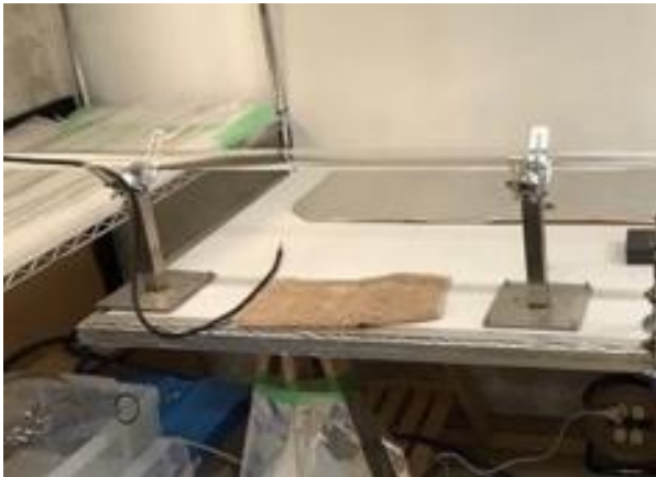
(図 37)口径可変型ガラス管専用回転台の設置
