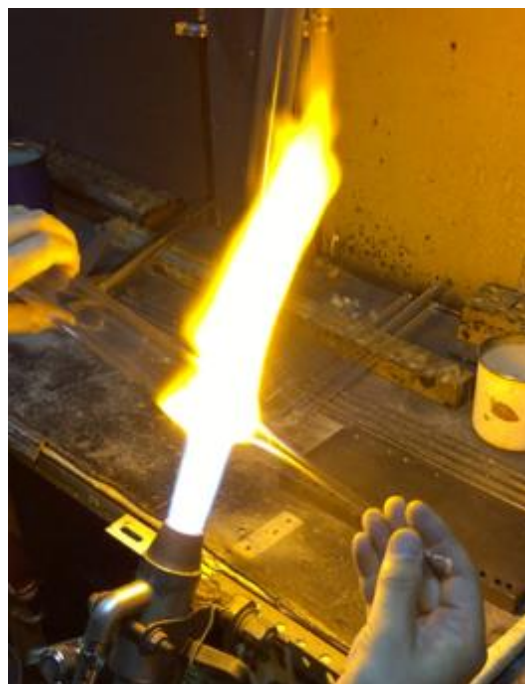
(図 34) 酸素バーナーによるガラス管成形作業 02
