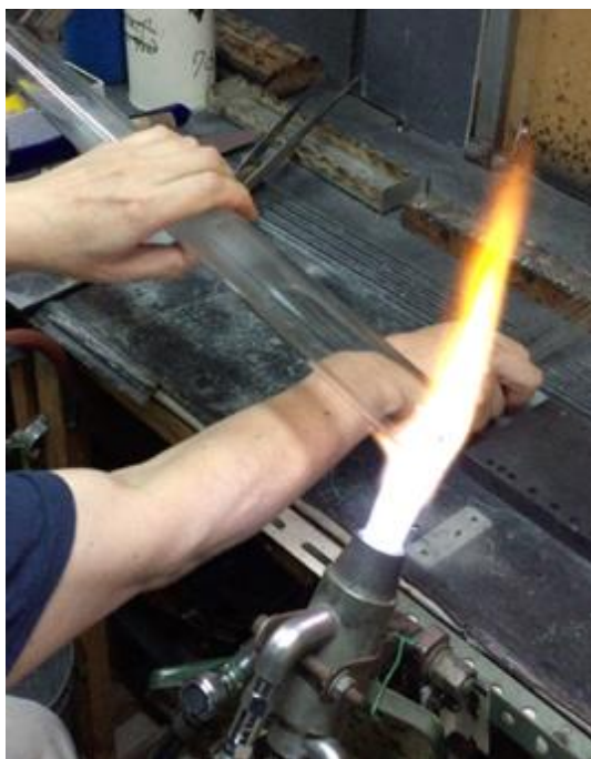
(図 33) 酸素バーナーによるガラス管成形作業 01
