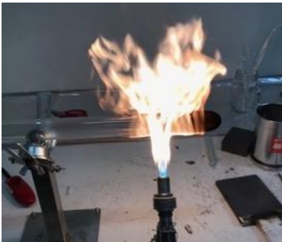
(図 41) ガスバーナーによる徐冷行程
