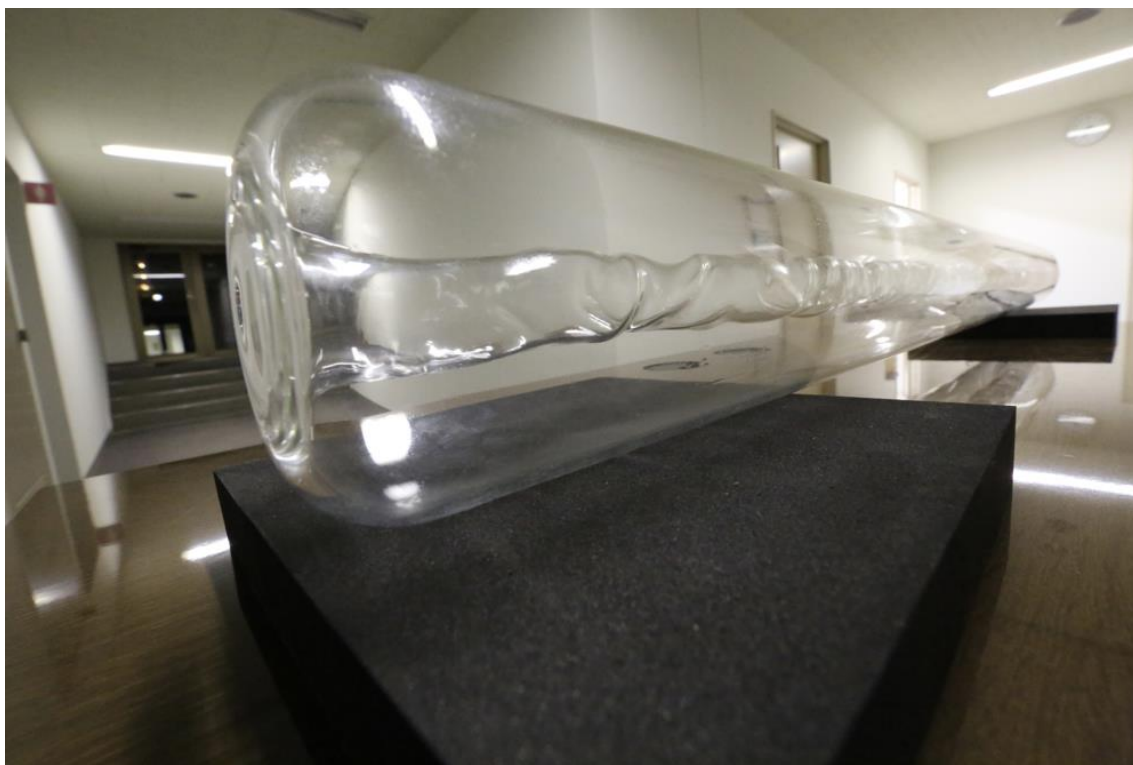
（図 74）大口径ポリシリケートガラスでの中空 2 重構造の制作 製造 有限会社桐山製作所
