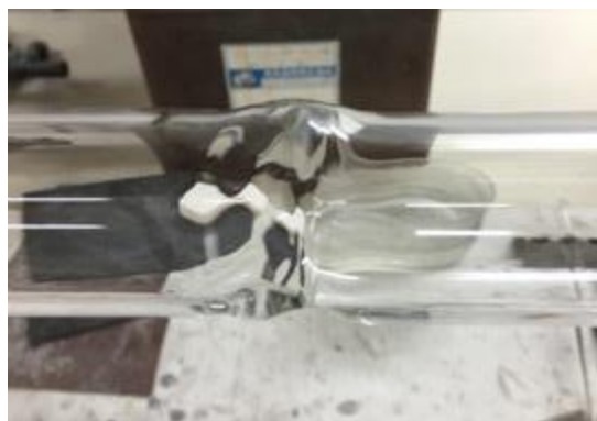
(図 36)同経ガラス管の接合箇所
