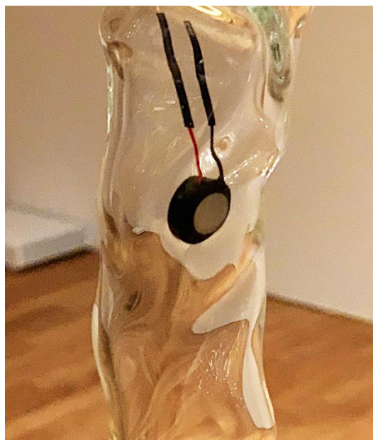
(図 54)ガラス管内に装着されたマイクロスピーカー
