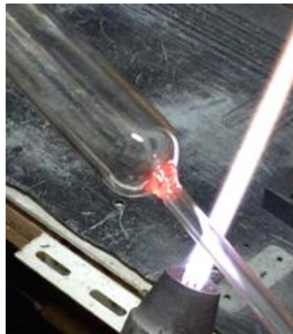
(図 42) ブロー用の吹き込み口の作成
