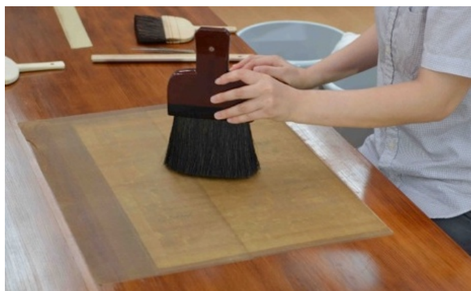
写真 4-1 打刷毛とその使用方法
