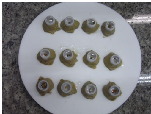
図 3-6 ポリエステル樹脂の固化
