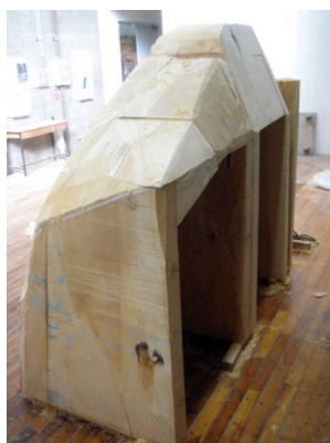
図 66 箱型に板材を組み合わせる
