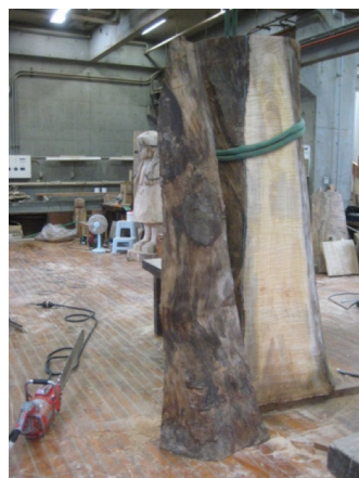
図 23 面を出すために製材している様子
