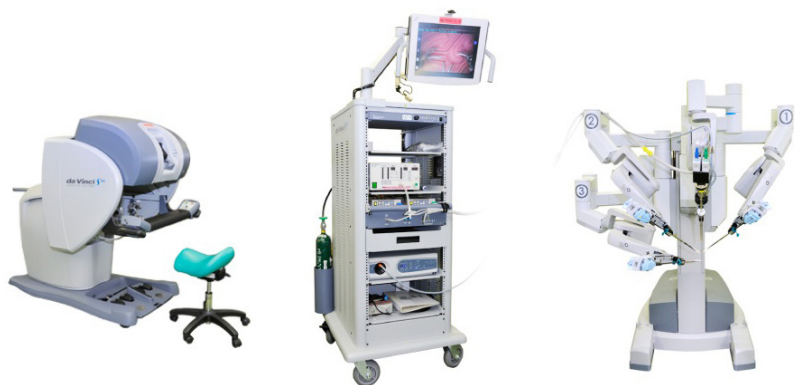
図15 左側はサージョンコンソール、中間はビジョンカート、右側はペイシェントカートサージョンコンソール、図版出所：東京医科大学病院 ダ・ヴィンチ徹底解剖WEBサイト、 http://hospinfo.tokyo-med.ac.jp/davinci/top/index.html
